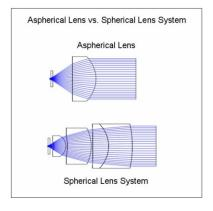
非球面透镜最大的特点就是至今为止的像差问题得到解决,因为通过的光量较多,无论多大的口径也没有像差。因此球面镜片需要 2-3 组合而成达到的效果非球面镜片 1 枚就可实现。这样,产品的小型化、轻量化乃至节省成本都变成了可能。
